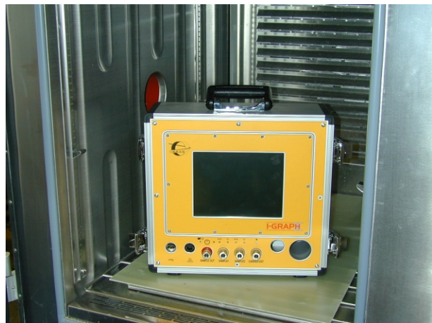
Prüfung eines elektronischen Datenerfassungsgerätes
